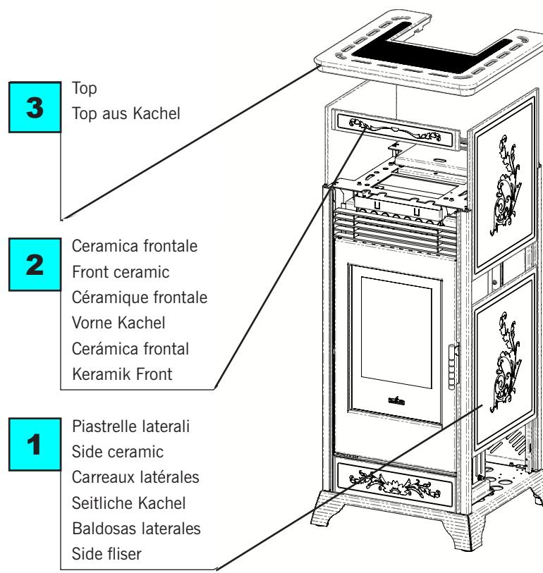
L'assemblaggio delle ceramiche laterali e frontale superiore, potrebbe richiedere l'utilizzo delle molle ricavate negli appositi montanti. In tal caso utilizzare un cacciavite a taglio per deformare le molle evidenziate in figura verso l'esterno.
