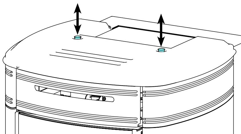
Come accedere alle botole di ispezione./ How to access the inspection hatches./ Comment accéder aux plaques d'inspection./ So gelangen Sie an die Inspektionsklappen./ Cómo acceder a las tapas de inspección./ Hvordan der fås adgang til inspekitionspladen.
